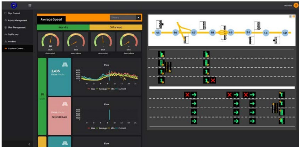
รูปที่ 3.3- 6 ตัวอย่างหน้าจอระบบควบคุมช่องทางพิเศษ (Reversible Lane)
